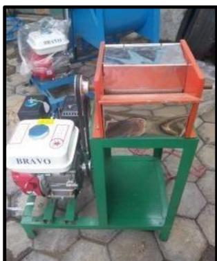
Gambar 5. Alat Parut menggunakan tenaga mesin
